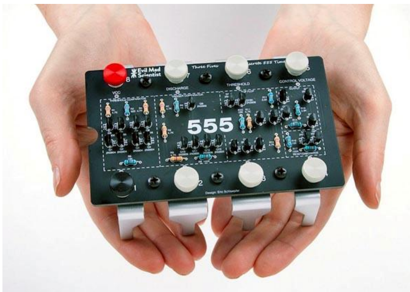
Рисунок 5. Набор дискретных компонентов для сборки таймера 555 поможет вам изучить многие принципы работы схемы.
